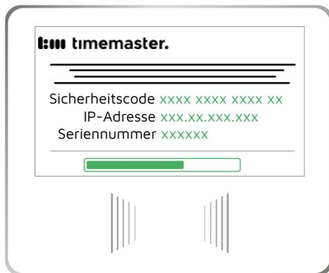
Das Terminal startet, sobald die Strom- und Netzwerk-Verbindung besteht.
