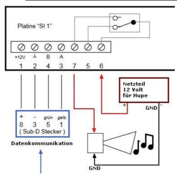
Das Schaltinterface verfügt über einen potentialfreien Relaiskontakt welcher maximal bis **48 Volt und 1 Ampere** belastet werden darf. Die Kontakte des Relais sind als Öffner/Schließer ausgeführt, sodass das Interface für viele verschiedene Einsatzzwecke verwendet werden kann.
